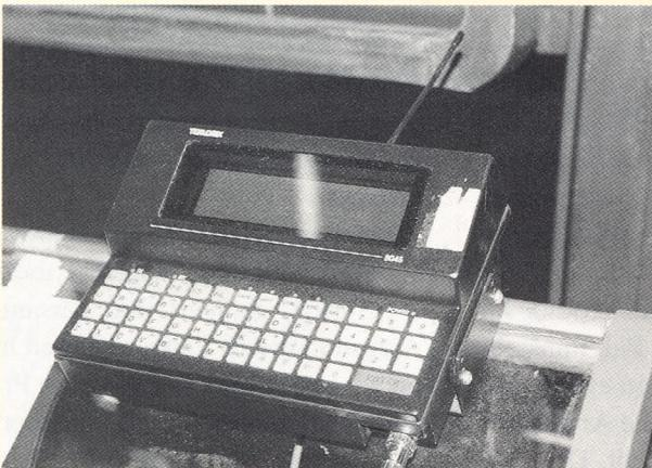
Die Fahrzeug-Terminals sind je nach Wunsch des Staplerfahrers entsprechend der Steuerkonsole oder unter dem Staplerhimmel installierbar.
